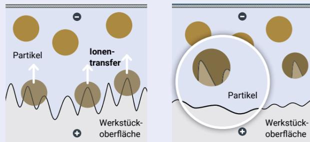
Basis ist eine speziell entwickelte Suspension aus funktionellen Partikeln und ionischen Flüssigkeiten. Diese befindet sich in einem Arbeitsbehälter, in welchen das Werkstück eingebracht wird. Durch das Anlegen einer definierten Stromquelle entsteht ein elektrisches Potenzial zwischen Kathode (-) und Anode/Werkstück (+).
