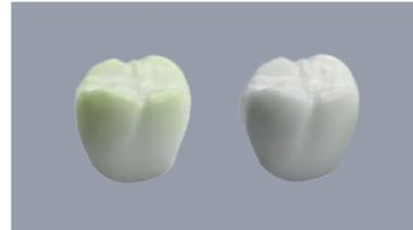
Die regelmäßige Durchführung von Reinigungsbränden unter Verwendung von DD phoeniX kann die Farbbeständigkeit und Reproduzierbarkeit Deiner Sinterergebnisse langfristig erhöhen.
